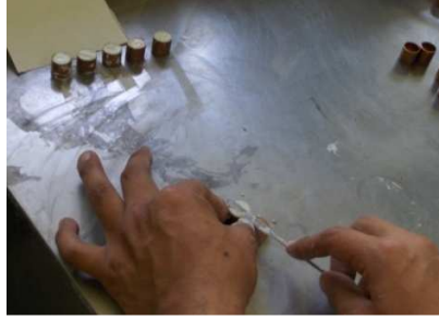
Figura 15. Elaboración de las pastillas para MEB.
