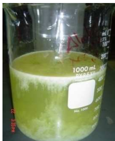
Figura 5. Mucílago precipitado en alcohol
