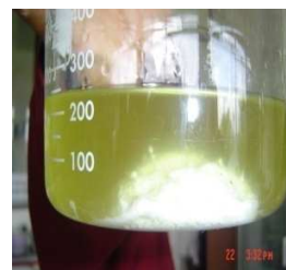
Figura 5. Mucílago precipitado en acetona
