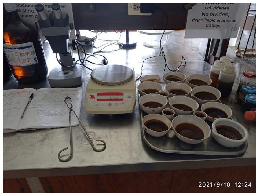
Anexo 21. Determinación de ST y SV de las muestras de sustratos en el laboratorio de suelos del CIIDIR, Oaxaca.
