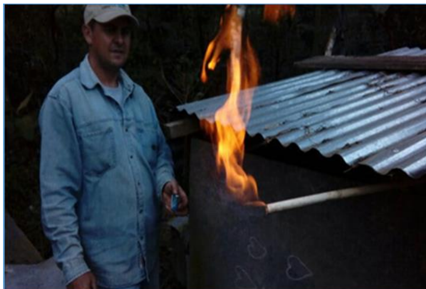
Figura 4. Prueba de llama con biogás obtenido a partir de la digestión anaeróbica de heces humanas en Sasle, Jinotega, Nicaragua.
