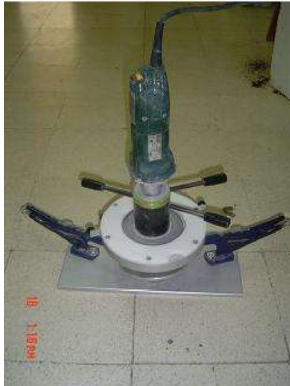
**Figura 14.** Herramienta extractora de polvos de concreto.
