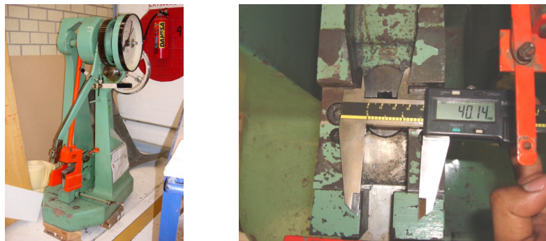
Máquina para ensayos de impacto Otto Wopert Werke y mordaza
