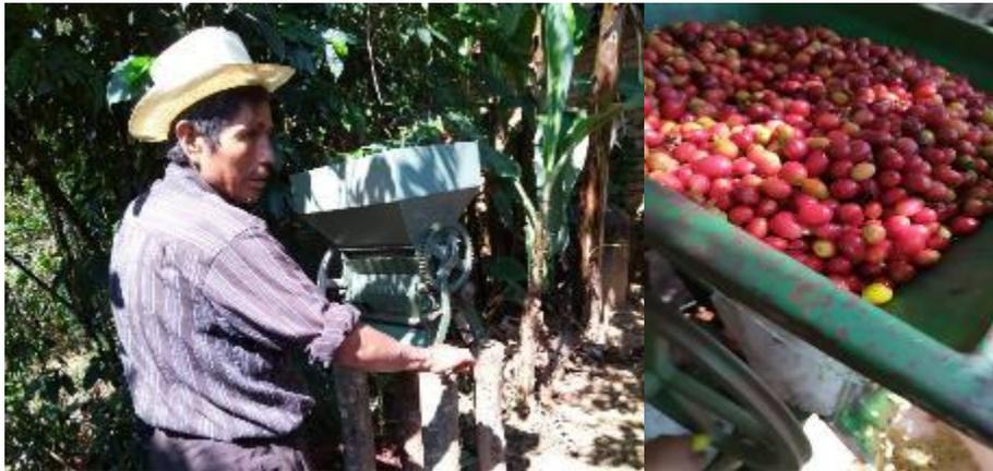
**Figura 20. Despulpado de café cereza**
