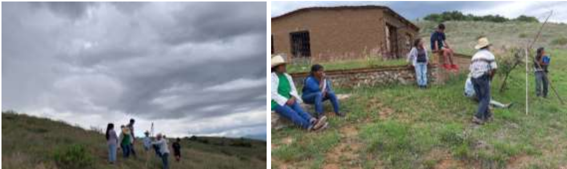
Figura 41. Participación de pobladores en práctica de construcción y uso de aparato A, utilización en campo para trazo de curvas de nivel.
