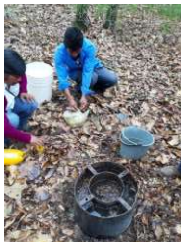
Figura 7. Verificación del nivel de agua en anillo interior y exterior del infiltrómetro. Fuente: Fotografía tomada en campo durante realización de pruebas de infiltración.
