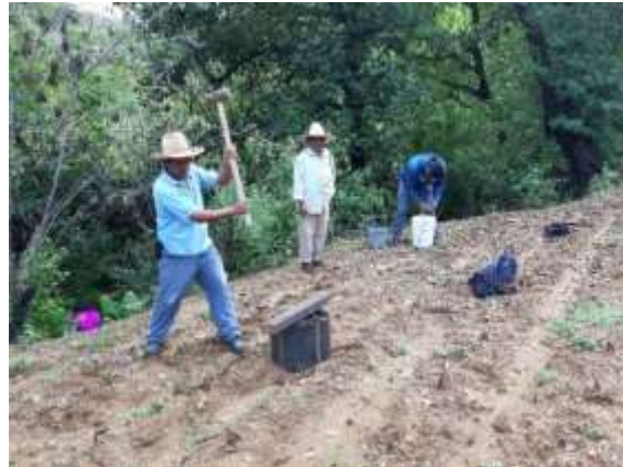
Figura 6. Instalación manual del infiltrómetro de doble anillo.
