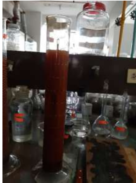
Figura 12. Toma de lectura con hidrómetro.
