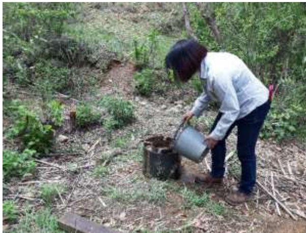
Figura 8. Rellenado de anillos exterior e interior de infiltrómetro. Fuente: Fotografía tomada en campo durante realización de pruebas de infiltración.
