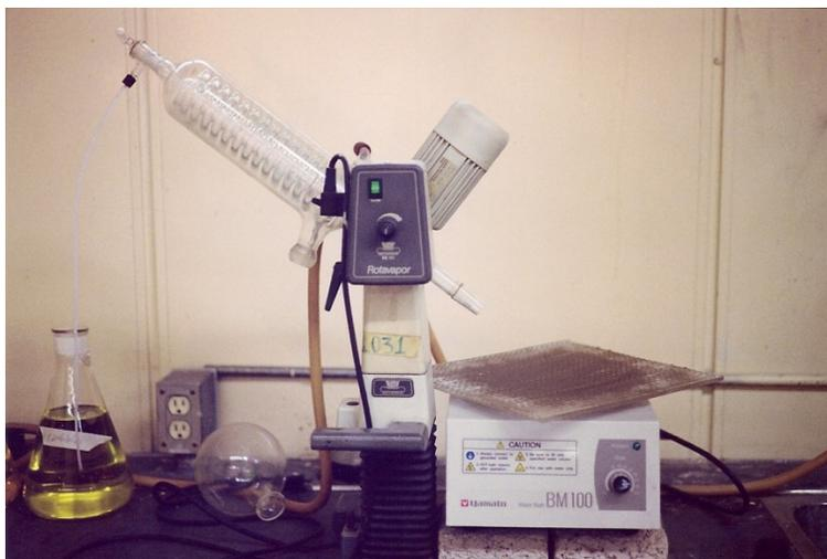
**Figura 7.** Rotavapor utilizado para destilar al vacío a sequedad.
