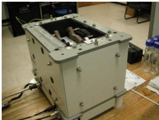
Figura 5.1 Arreglo de magnetos permanentes de un espectrómetro MARAN DRX-HF 12/50
