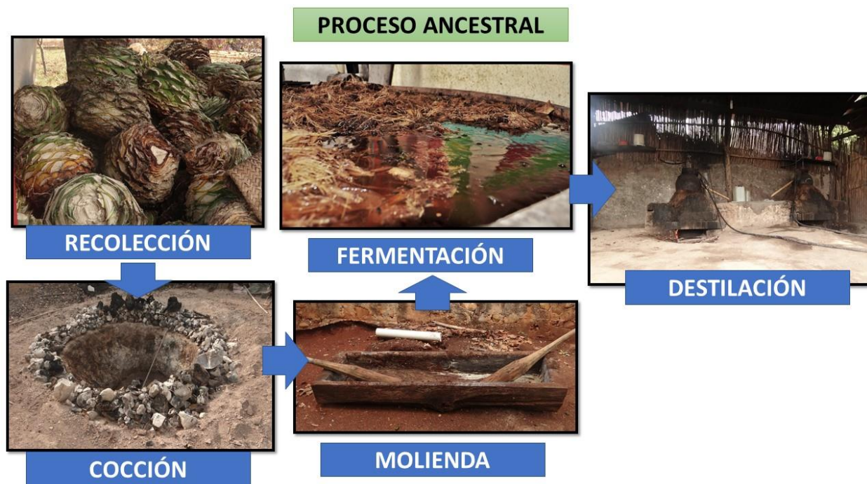
Figura 28. Diagrama fotográfico del proceso ancestral de elaboración de mezcal.
