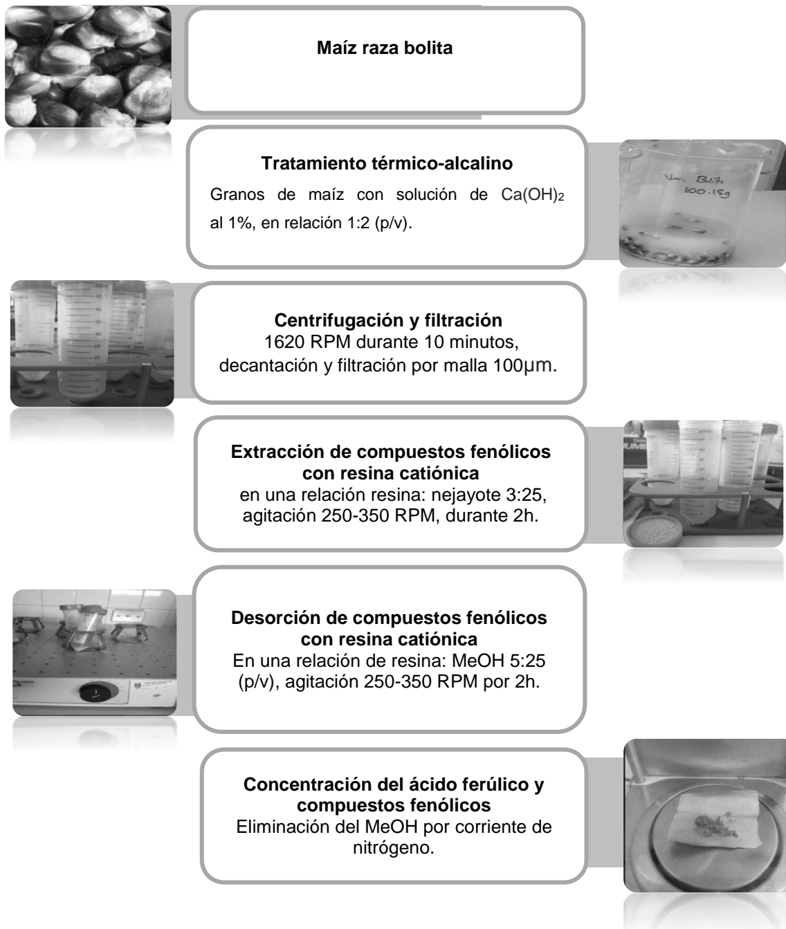
Diagrama del proceso de obtención de nejayote, concentración y purificación de los ácidos fenólicos mediante el empleo de resinas.
