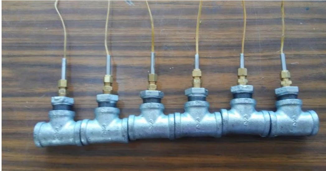
Figura 15. Arreglo de termopares tipo K
