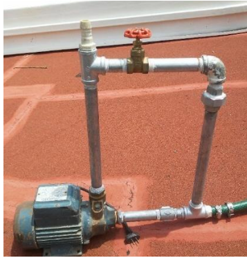
Figura 13.- Sistema Feedback para el control de flujo de agua
