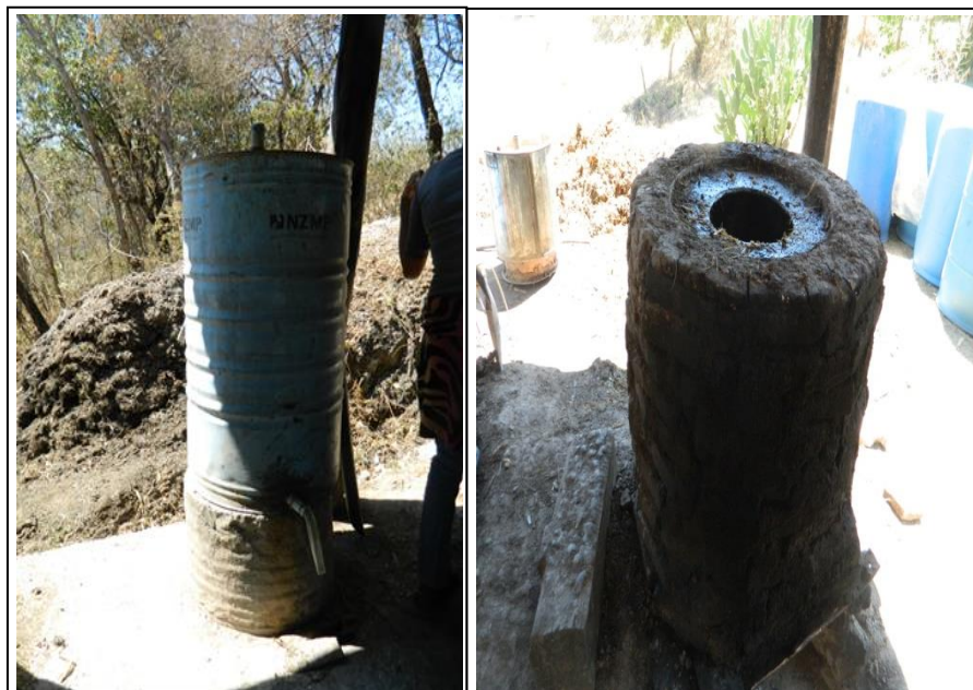
Figura 6 .Foto palenque con sistema de destilación tambo
