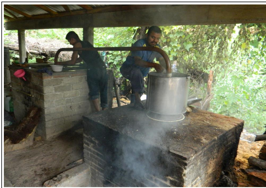
Figura 5. Foto palenque artesanal con sistema de destilación alambique
