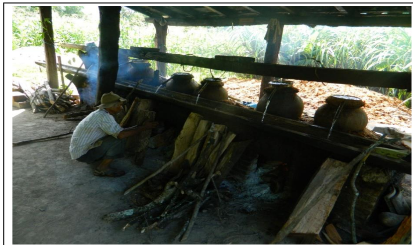
Figura 4. Foto palenque artesanal con sistema de destilación de olla de barro
