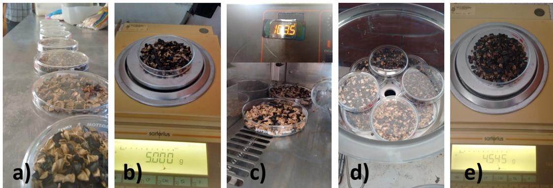
**Figura 13.** Determinación de contenido de humedad a) Preparación de muestras en Cajas Petri; b) Peso inicial de la muestra ajustado a 5.000 ± 0.001 gr; Secado en estufa a 103° ± 0.5 gr por 17 horas; d) Desechado por 30 minutos; e) Peso final de la muestra con precisión ± 0.001.
