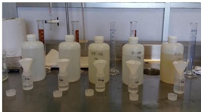
**Figura 15** Preparación de muestra para el análisis de aniones.
