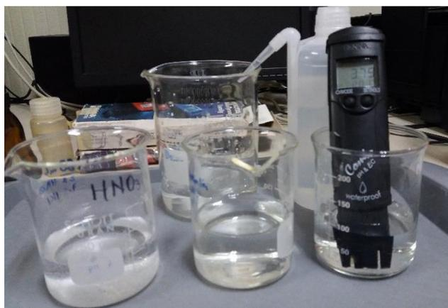
**Figura 14** Calibración del equipo Combo HANNA 98130 a pH 4, 7 y 10.
