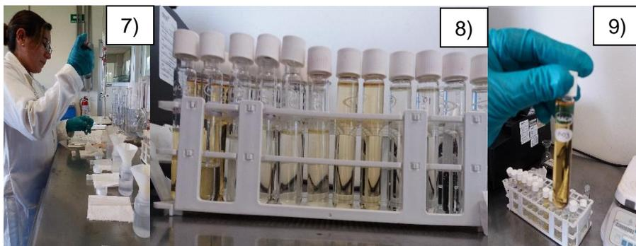
7) muestra de 10 ml, 8) gradilla de tubos de reacción con las 10 muestras, testigo y patrones, 9) muestra con contenido alto de nitratos (método sulfato de brucina).
