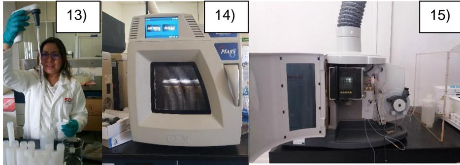
13) Preparación de la muestra para digestión, 14) horno de microondas para digestión de la muestra a 170°C en una rampa de 25 minutos, 15) Lectura de las muestras en ICP-masas para 32 metales
