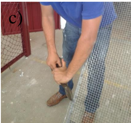
Figura 12. Construcción de los marcos de lavado a) cortado del material b) soldado del marco C) corte de la malla y d) soldado de la malla en el marco
