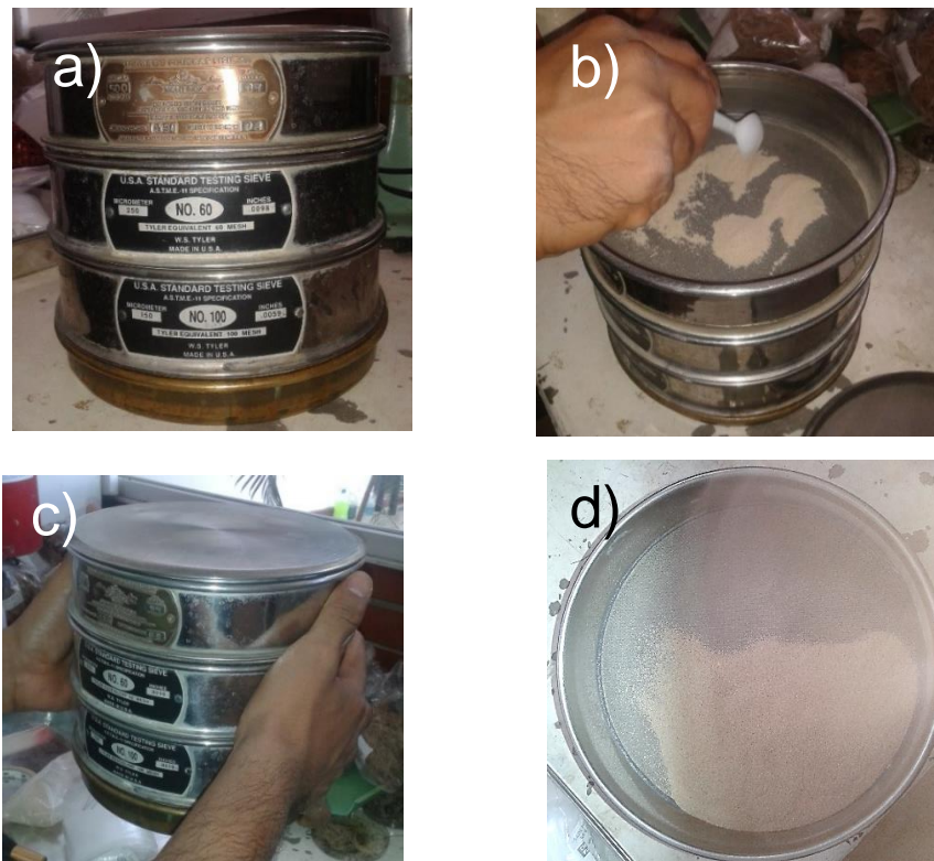
Figura 15. Secuencia de tamizado de fibras a) preparación de tamices b) colocación de la fibra, tamizado a mano y d) fibra seleccionada
