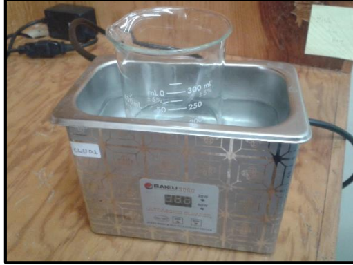
Figura 32. Lavado de los discos con acetona en tina ultrasónica.
