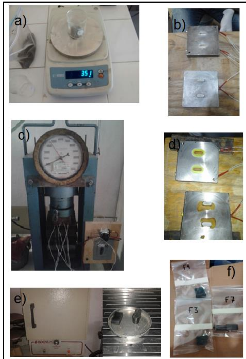
Figura 28. Proceso de fabricación de las muestras a) pesado del material al emplear, B) llenado de las cavidades del molde) moldeo, d) extracción de las muestras E) curado de 8 h y f) embolsado y etiquetado
