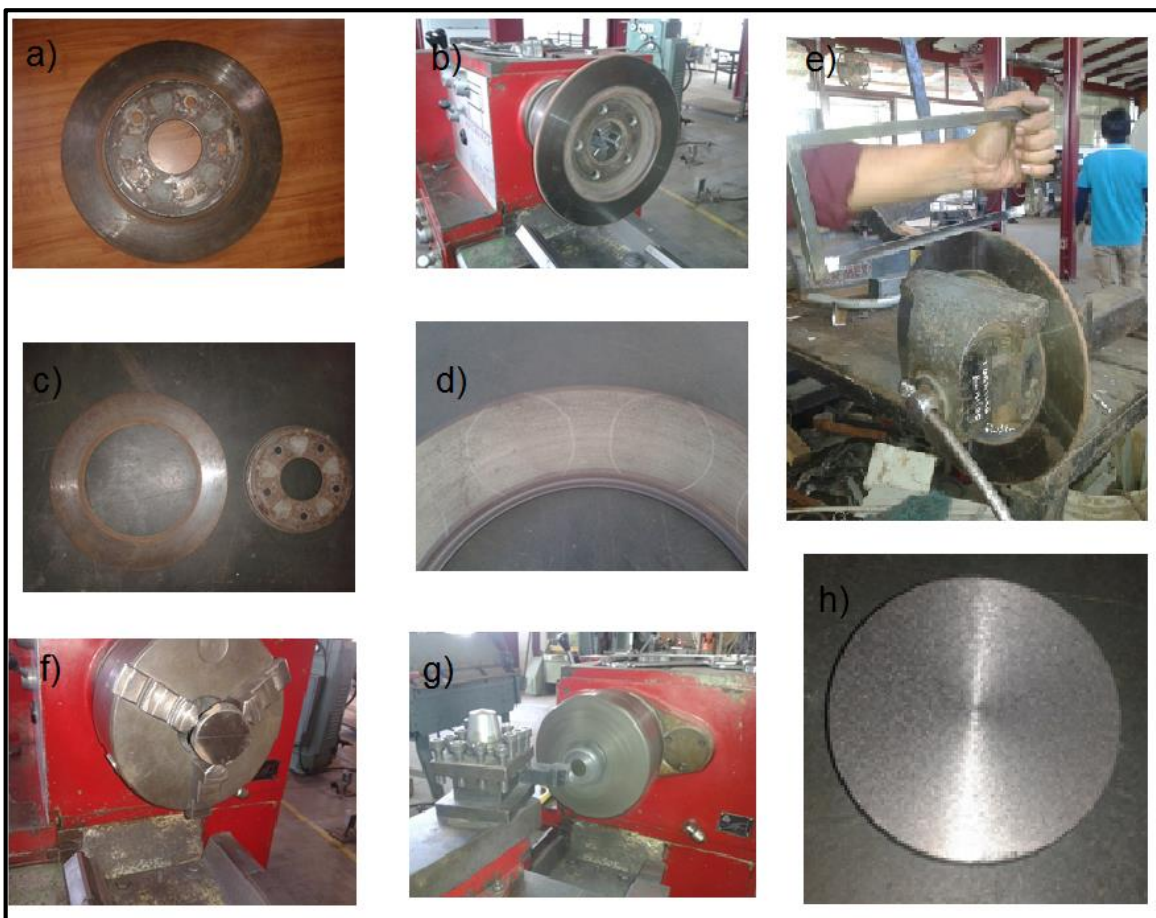
Figura 29. proceso de obtención de los discos de prueba a) disco usado de automóvil, B) corte del núcleo ,c) separación del núcleo y área de contacto, d) marcas de corte, e) corte manual del área marcada) cilindrado, g) refrentado y h) disco terminado
