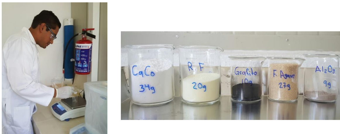
Figura 17. Medición del peso de los ingredientes a) empleo de la balanza y b) materiales listos para mezclar
