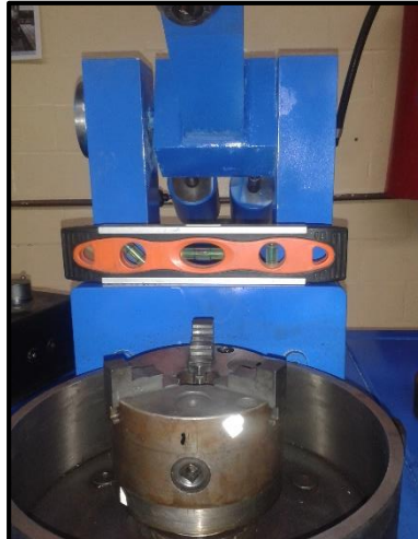
Figura 37. Ajuste y nivelación de la máquina de pruebas
