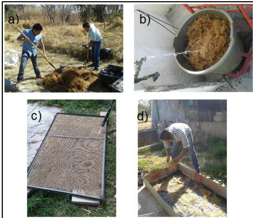
Figura 13. proceso de lavado del bagazo de agave a) pre selección de la fibra, b) remojo c) lavado a presión y d) secada al sol.
