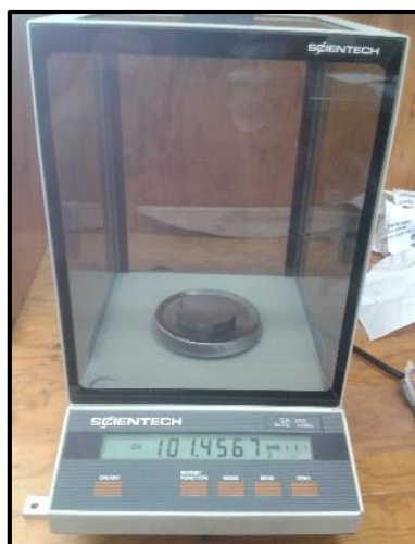
Figura 35. Medición del peso de las muestras antes del ensayo
