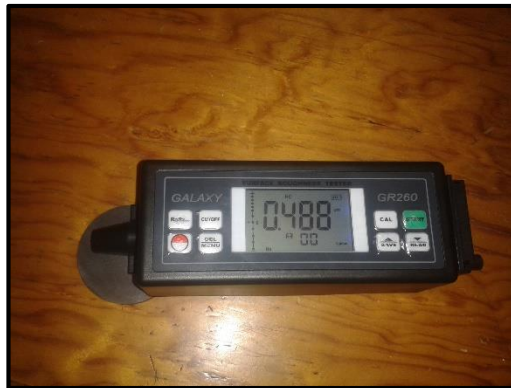
Figura 33. Medición de la rugosidad de los discos
