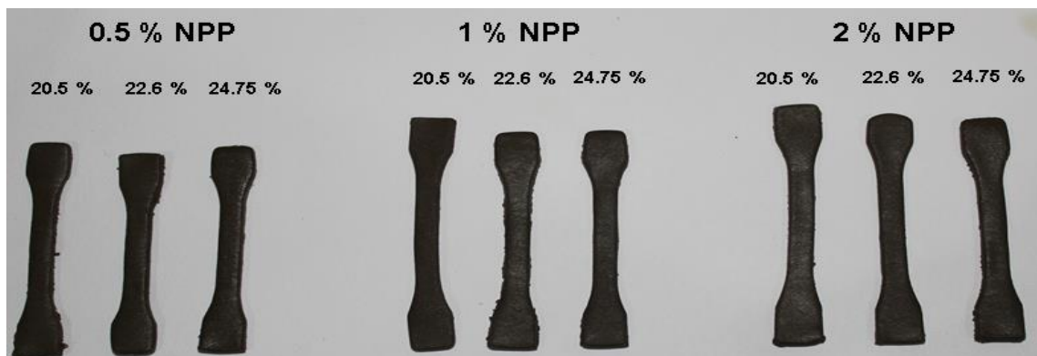
Figura 4.8. Nanocompósitos a base de almidón de papa con diferente humedad, reforzadas con distintas cargas de NPP.
