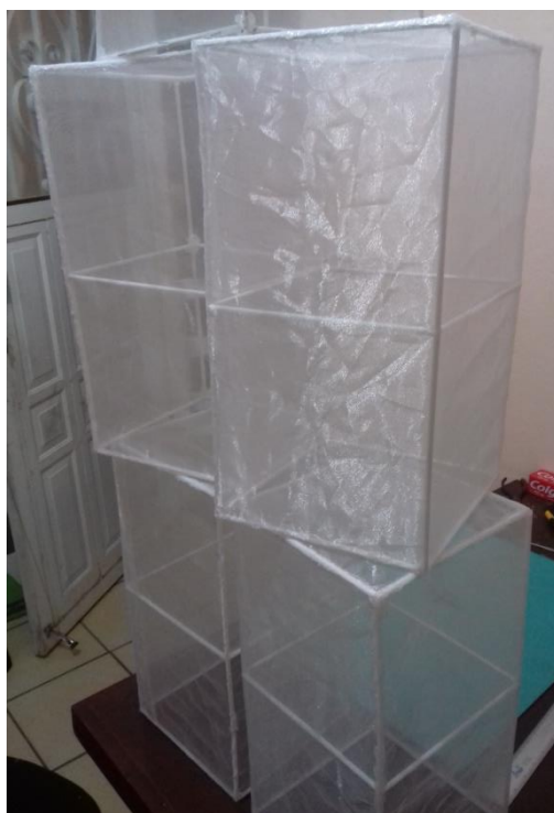
Figura 14. Jaulas (0.2m x 0.2m x 0.4m) con armazón de tubos plásticos pegados con silicón y cubiertas con tela de organza con un volumen de 16 L para la cría de T. triozae . Fotografía: Eliel Esaú Mesinas Matias.
