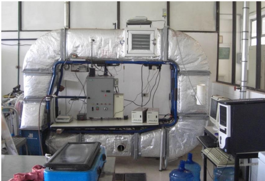
Figura 10 Túnel de secado para pruebas piloto
