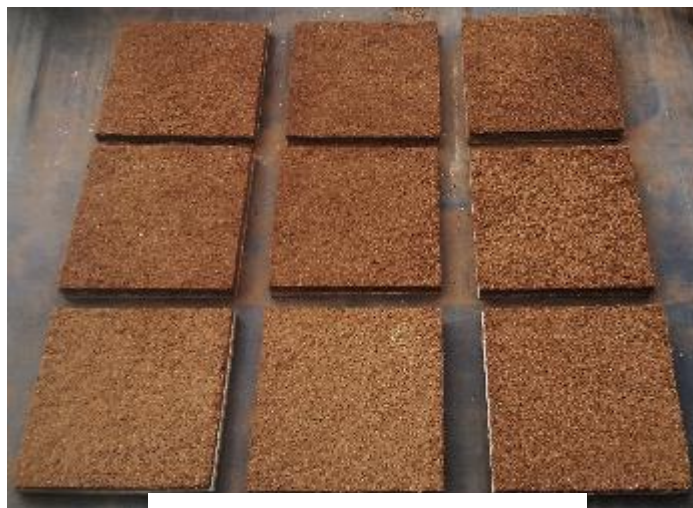
Fig.3.21. Curado de paneles 28 días
