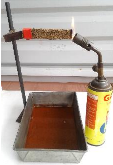
Fig.3.34. Colocación muestra hule natural.
