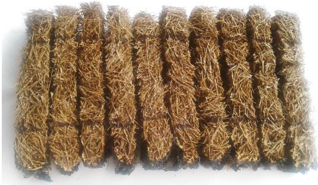
Fig.4.25. Muestras de resina de urea formaldehido quemadas.
