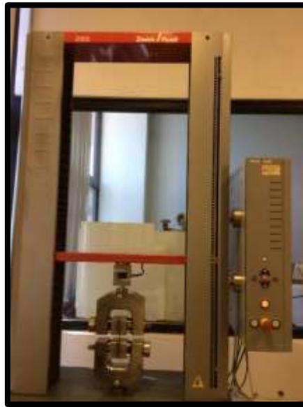
Figura 20. Ensayo de tracción en un equipo universal Zwick/Roell Z005.
