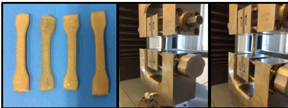
Figura 40. Ensayo de tracción del bioplástico
