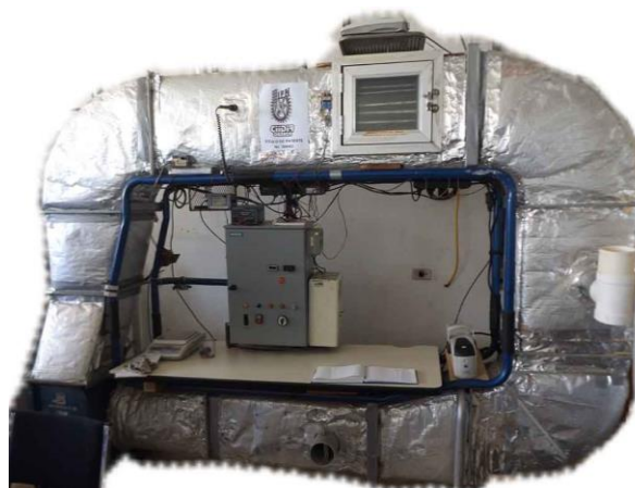
Figura 9. Secador de bandejas tipo túnel con número de patente 304462.
