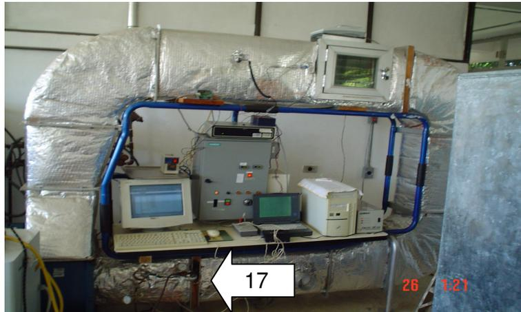
Figura. 17. Túnel de secado con bomba de calor durante el experimento 1
