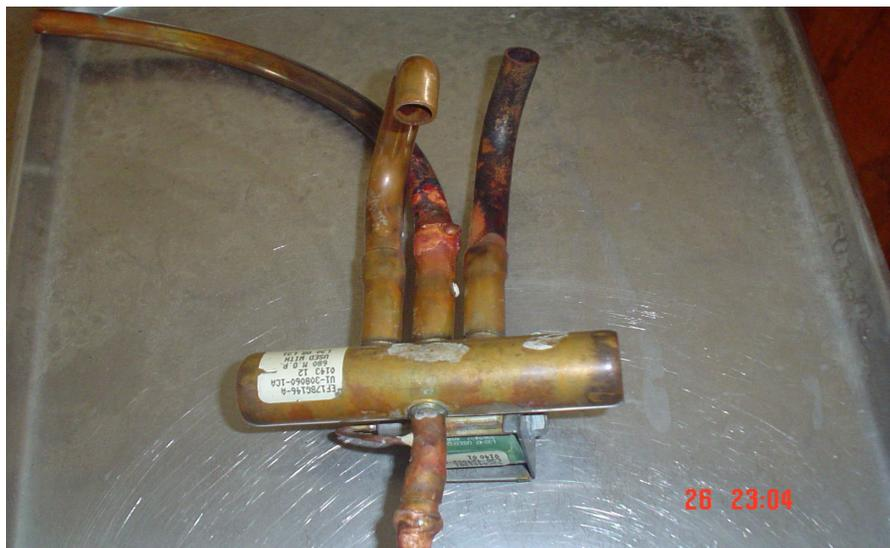
Figura. 20. Válvula reversible de cuatro vías
