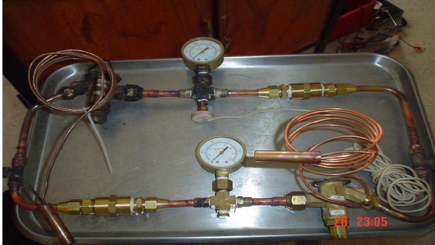
Figura. 21. Circuito de dirección del Refrigerante
