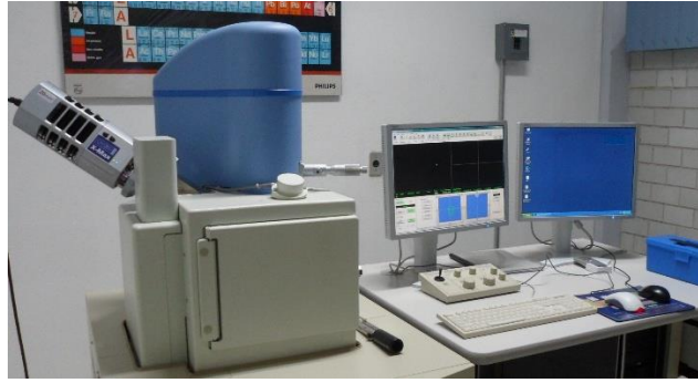
Fig. 30 Microscopio Electrónico de Barrido marca JEOL modelo JSM-6610LV equipado con analizador EDS marca OXFORD, modelo X-MAX.
