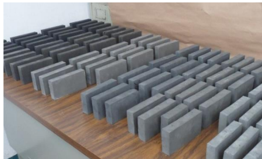
Fig. 16 Proceso de secado de ladrillos elaborados con mezclas ternarias.
