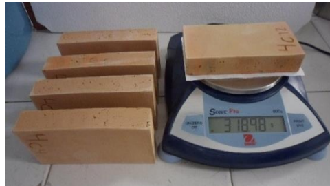
Fig. 25 Pesaje de ladrillos secos para la pruebas de absorción
