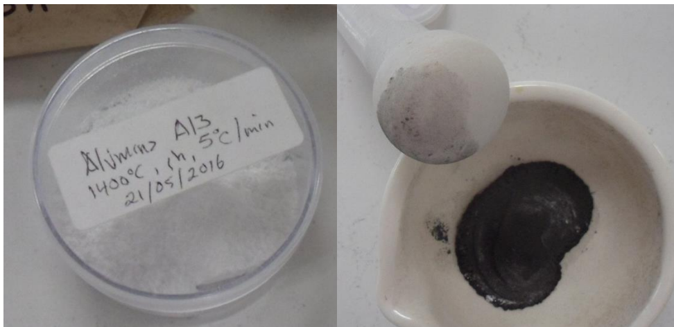
Fig. 4 Preparación de muestra de CBC con alúmina A13 para determinación del contenido de fase amorfa a partir de patrones de DRX.
