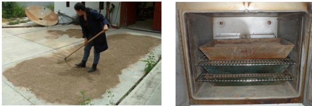
Fig. 2 Disgregado y secado de la arcilla al sol y en horno eléctrico.
