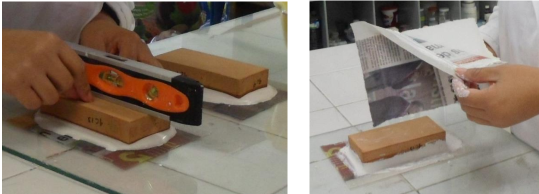
Fig. 21 Proceso de cabeceo de ladrillos para ensayo de resistencia a compresión.
