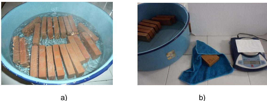
Fig. 27 Ensayo de absorción por hervido durante 5 horas
