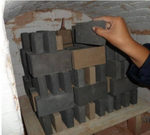
Fig. 17 Acomodo aleatorio de los ladrillos verdes al interior del horno
