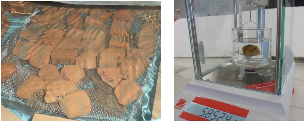
Fig. 24 Hervido y pesaje de especímenes para determinar porosidad y densidad
