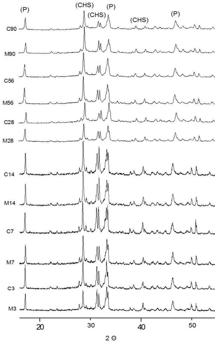
**Figura 4.8** Difractogramas obtenidos para las pastas de cemento portland conteniendo 1% (w) de mucílago de nopal (M) hasta 90 días de hidratación y sus respectivos controles (C).
