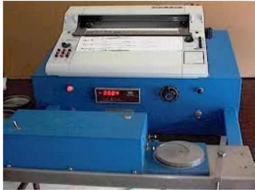
**Figura 4.** Celda de Jenike utilizada para pruebas de corte directo en materiales granulares.
