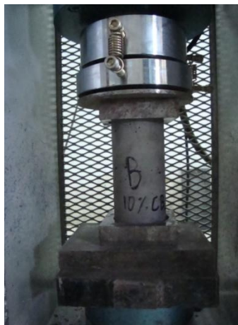
Figura 22: Ensayo de resistencia a compresión de cilindros
