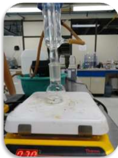
Figura 9. Calentamiento del matraz con \text{CH}_3\text{OH} y \text{BF}_3 durante la metilación
