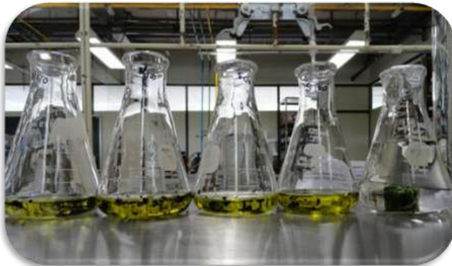
Figura 16. Coloraciones en las microalgas después de la Sonicación. (De izq a derecha: N. oleoabundas a 40°C, N. oleoabundans a 100°C, Scenedesmus sp. a 40°C, Scenedesmus sp. a 100°C, Mtra fresca de N. oleoabundans )
