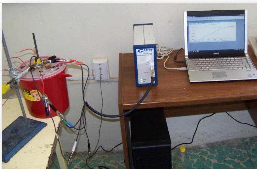
Figura 16- Potencióstato Gamry Instruments, Inc. PCI4/750, conectado a celda electroquímica.
