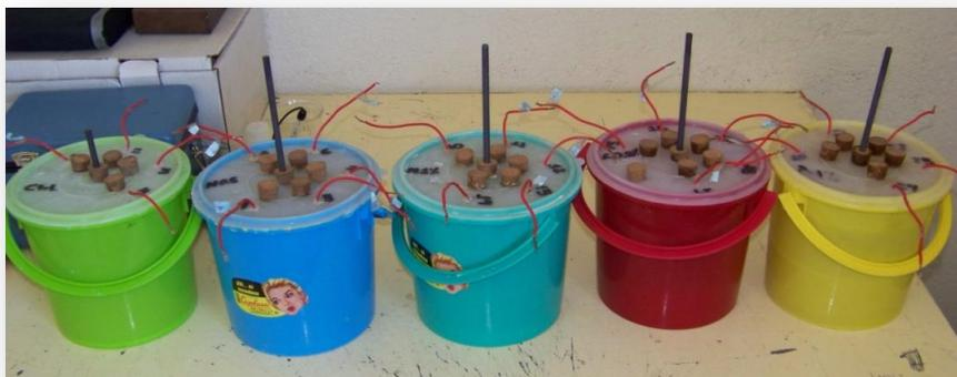
Figura 14- Celdas electroquímicas control (agua), con mucilago (0.5% y 1%) y alginato (0.5% y 1%).
