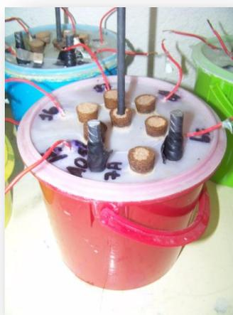
Figura 15- Celdas electroquímicas con 7 varillas de acero de refuerzo
