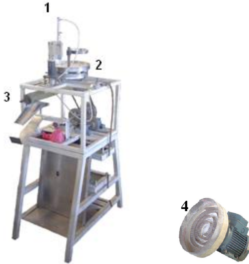
Figura 3. Encapsuladora de nematodos: 1) Dosificador neumático de la solución acuosa conteniendo nematodos 2) Conos de alojamiento del material granular para la formación del pellet 3) Tornillo sinfín transportador-precompactador 4) Disco compactador.
