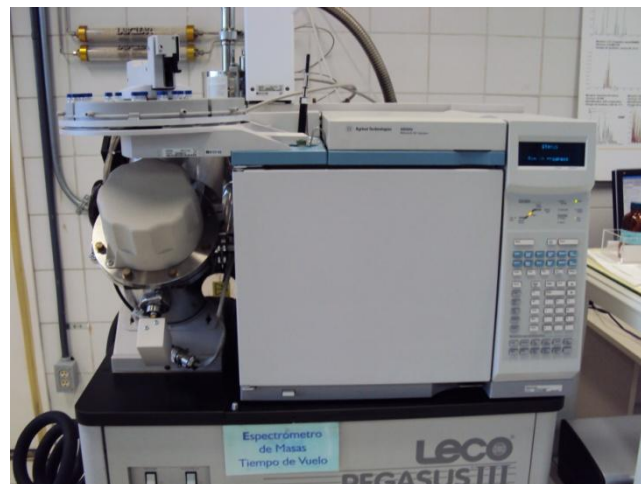
Fig. 16 Cromatógrafo de gases Agilent 6890 N, equipado con un detector de masas de tiempo de vuelo (TOF) LECO Pegasus 4D.
